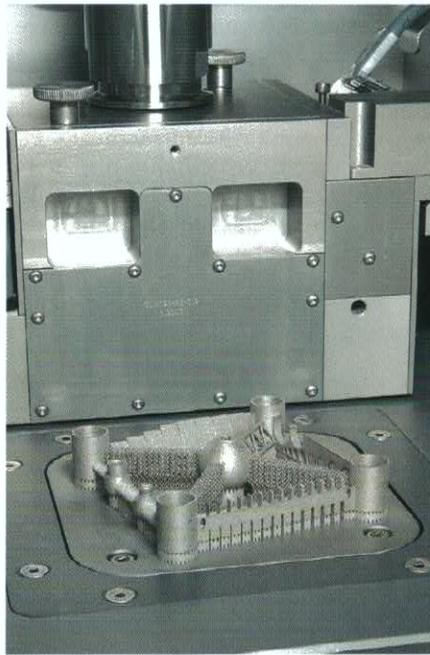
Im „LaserMelting-Prozess“ gefertigtes Bauteil: Mithilfe von CAD-Daten entstehen aus Metallpulvern durch 3D-Lasertechnologie homogene Metallobjekte. Bild: SLM
