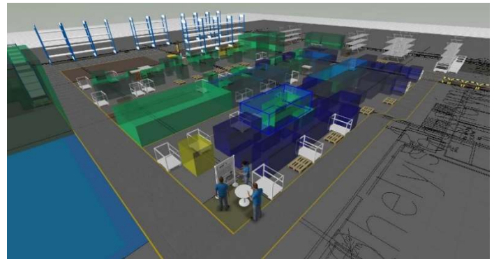
Abbildung 1: 3D-Modellierung des Fabriklayouts
